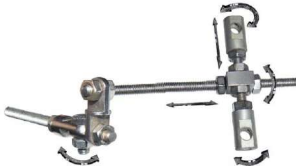
Рис. 4.4 Ступені рухливості репонуючих вузлів в репонуючій опорі
