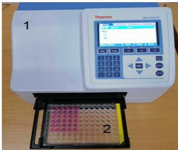
Рисунок 2 – Визначення цитотоксичності досліджуваних зразків із використанням фарбника Alamar Blue: 1 - планшетний зчитувач; 2 – планшет з фарбником Alamar Blue
