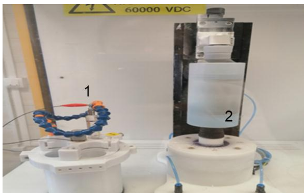
Рисунок 1 – Система електропрядіння: 1 – шприц з розчином хітозану; 2 – колектор з нановолокнами
